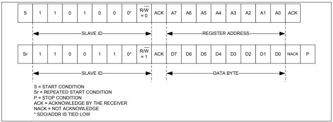
Figure 27. I<sup>2</sup>C Single-Byte Read Transaction
